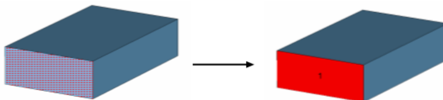
Рис. 1.57. Выделение поверхности волновода для постановки порта
