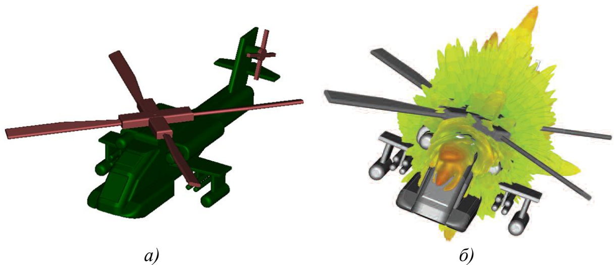
Рис. В.3. Экспортированная модель вертолета (а) и рассчитанный трехмерный график эффективной площади рассеяния (б) [1]
