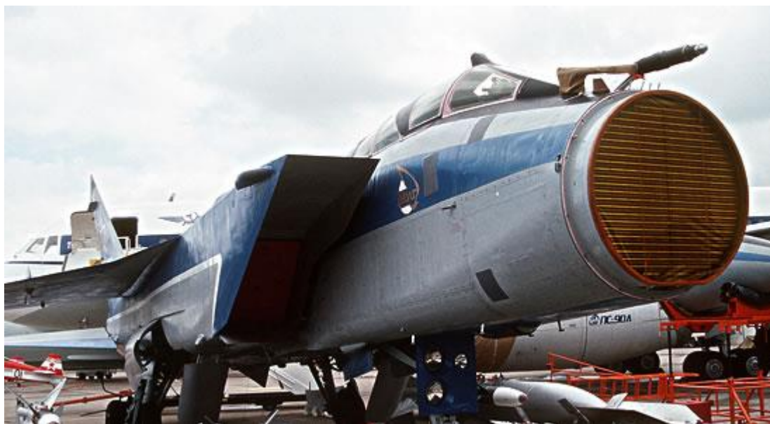
Рис. 7.1. МиГ-31 – первый в мире серийный истребитель, оснащённый РЛС с пассивной ФАР (ОАО «НИИП имени В.В. Тихомирова»)
