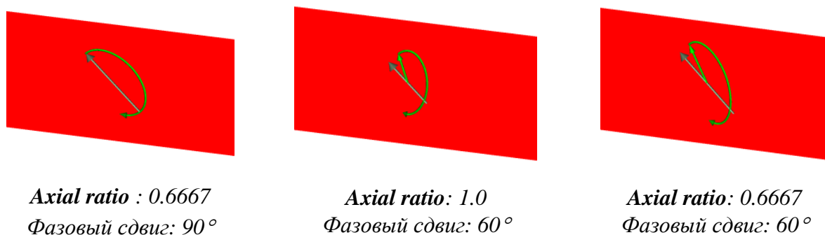
Рис. 1.96. Планарная волна с разными поляризациями
