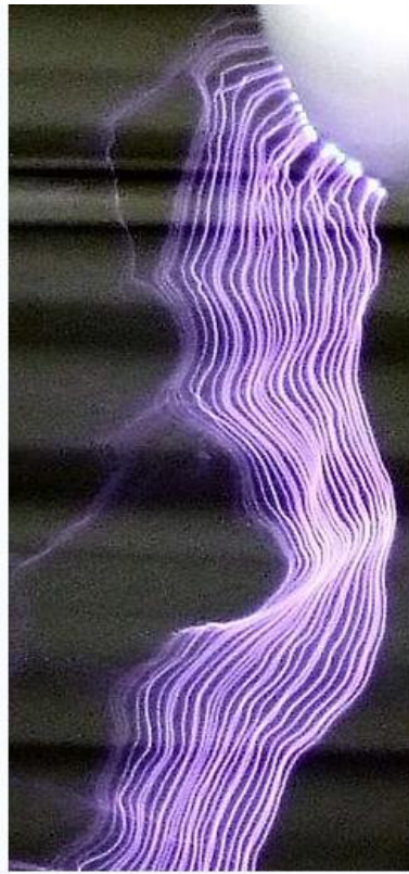
Рис. 13.2. Линии электрического пробоя из-за электрического разряда
