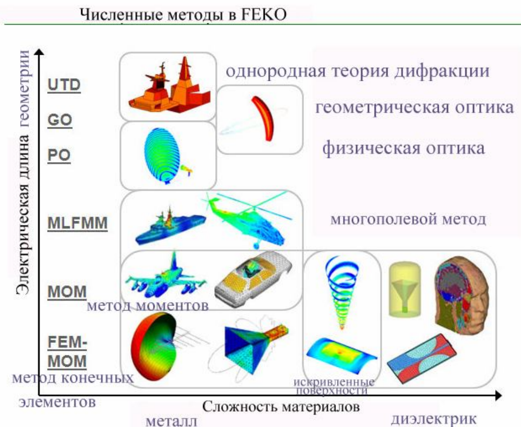
Рис. 2.1. Применение различных методов, реализованных в FEKO для решения различных задач
