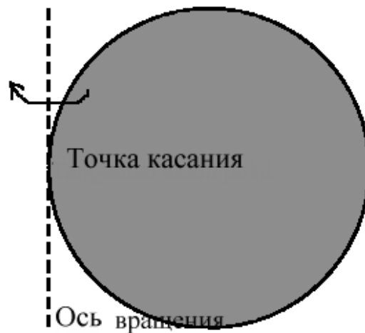
Рис. 6.16. Пример поверхности с ребром, который касается оси вращения
