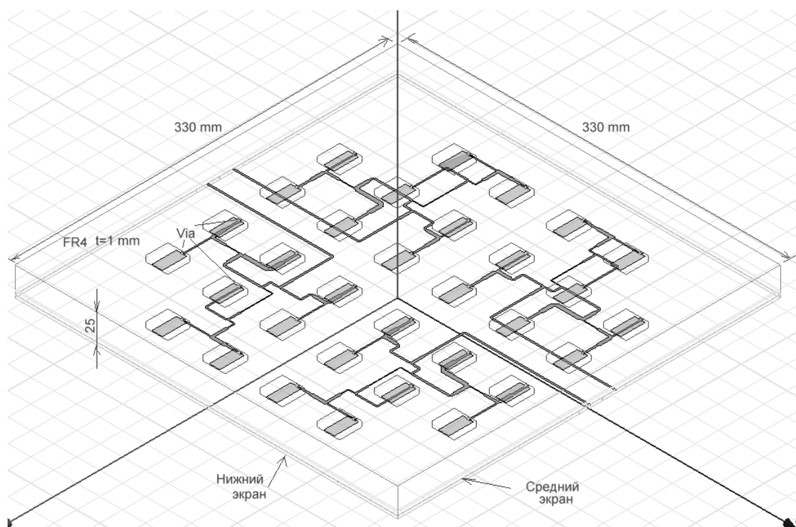
Рис. 11.2. Антенная решетка, работающая на частоте 4.6 ГГц и состоящая из 32 излучаемых элементов (4 блока по 8 элементов)
